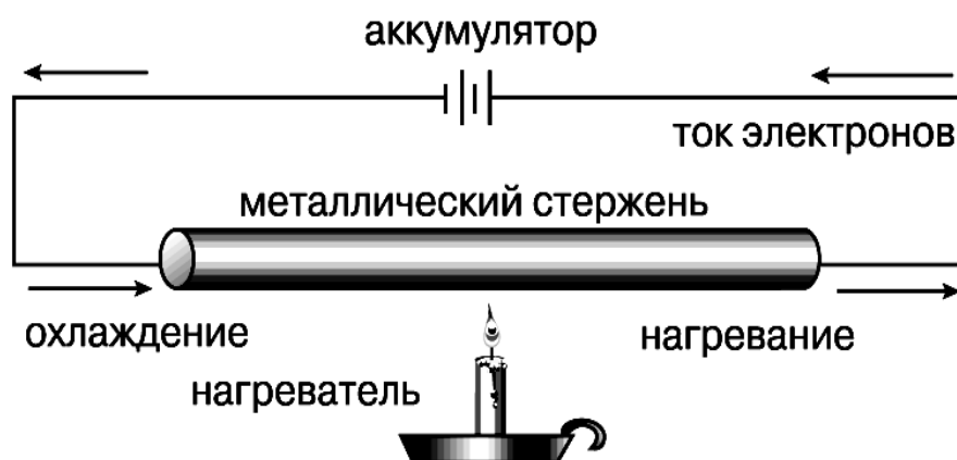
Рис. 2.12. Электротермический эффект Томсона. При пропускании тока через проводник, нагреваемый в средней точке, один его конец немного нагревается, а другой слегка охлаждается. Какой именно нагревается, а какой охлаждается – зависит от направления тока в цепи
