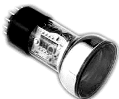
Рис. 3.16. Внешний вид и принцип действия динодного вторично-электронного умножителя
