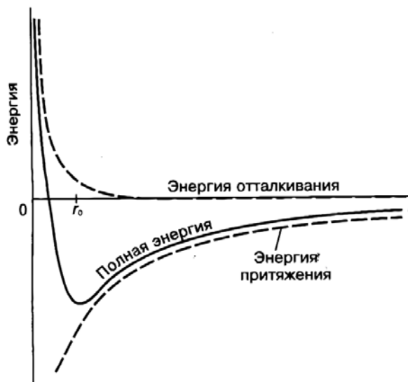
Рис. 1.1. Зависимость сил электрического притяжения и отталкивания между двумя атомами от расстояния между ними r [1]
