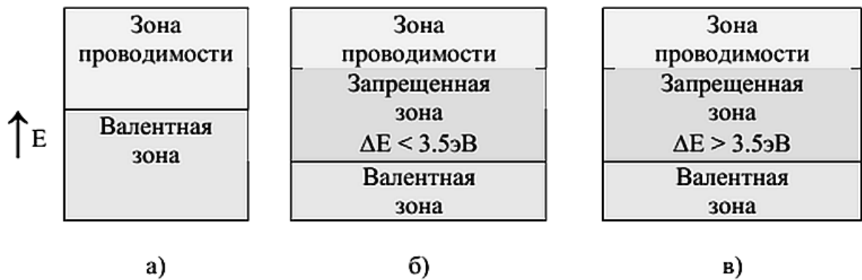
Рис. 2.2. Структура энергетических зон в проводниках (а), полупроводниках (б) и диэлектриках (в)
