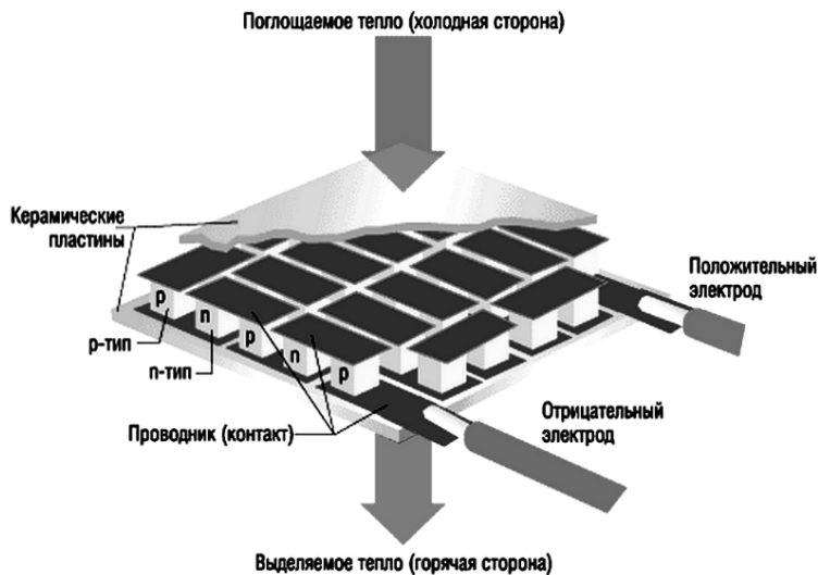
Рис. 2.10. Структура полупроводникового модуля Пельтье
