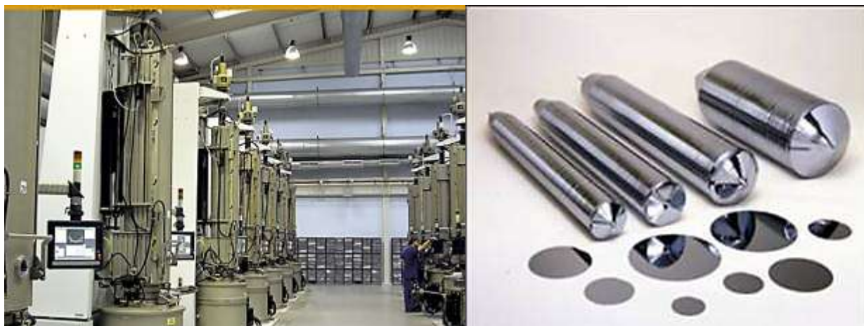
Рис. 3.13. Промышленное выращивание монокристаллов кремния методом Чохральского
